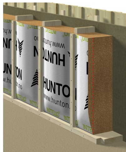
Iliustracijoje parodyta „Nativo“ medienos pluošto purškiamą izoliaciją, izoliuota siena.
